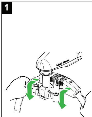
Coloque el accesorio alrededor del bastidor, con los pulsadores hacia delante.
