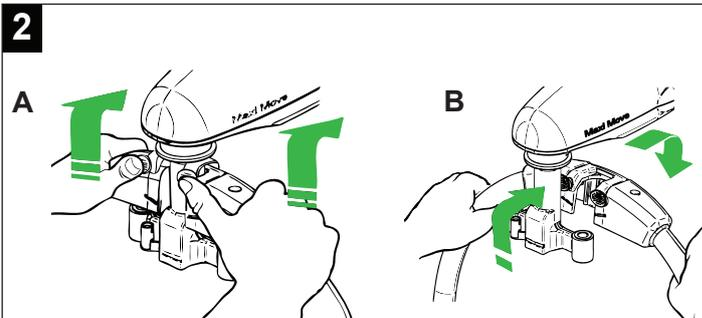
Levante el accesorio (A) y sepárelo (B) del bastidor.
